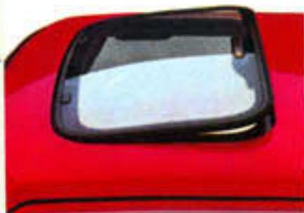
Panoramadach, hinten hochstellbar oder ganz herausnehmbar. Wahlweise aus durchsichtigem, getöntem Sicherheitsglas oder als Stahldach in Wagenfarbe\*
